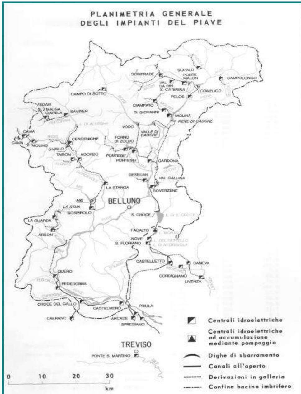
Fig. 5. Planimetria generale degli impianti ENEL nel bacino del Piave – fonte ENEL.
